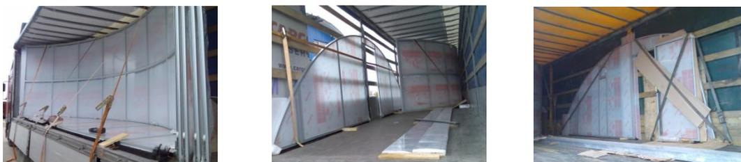
Торцевые стенки, двери, ходовые пути и другие отдельные элементы крепятся к стойкам и полу кузова ремнями и раскрепляющими приспособлениями.
