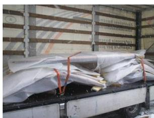
В этом случае высота тента автомобиля не имеет большого значения, но параметры ширины и длины кузова сохраняются. При этом автомобиль должен обязательно быть укомплектован транспортировочными ремнями в количестве не менее 4-х штук.
