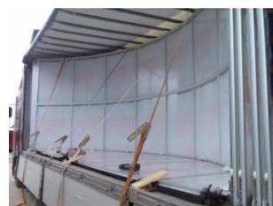
Дно кузова автомобиля должно быть деревянным, для того, чтобы была возможность произвести раскрепление, отвечающее требованиям транспортировки павильона без повреждений.
